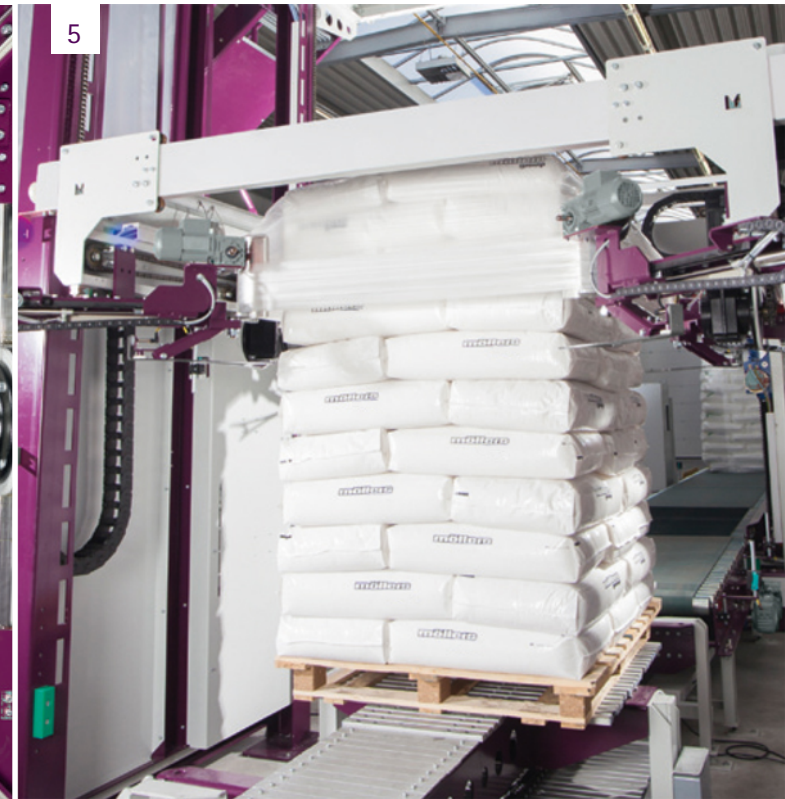
6a. Foliенabschluss mit Bündelstretch Film end with bundle stretch
